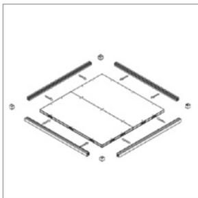
Si la chambre n'a pas des panneaux de sol, la fixation du vertical sera selon la figure A. Le sol du périmètre de la chambre doit être parfaitement de niveau d'une largeur E+150 mm.
